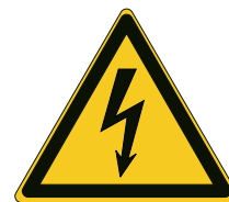
Gevaarlijke elektrische spanning W012
