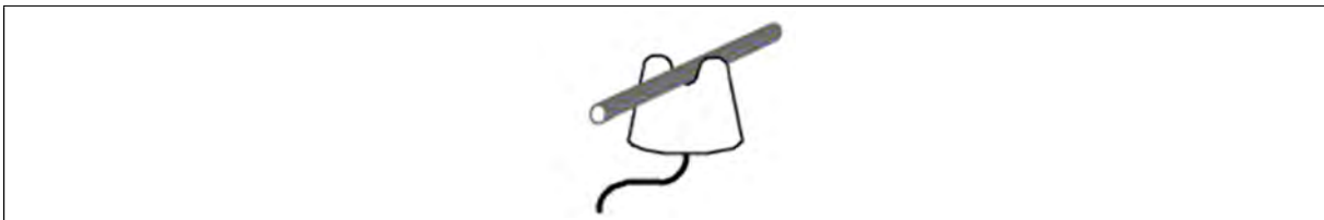
Figuur 5.24. Plaatsingswijzen van elektrische leidingen – Op isolatoren
